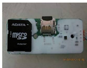
Рис. 5. Аналогово-цифровой преобразователь CAN-USB: ZET 7174 регистрирующего устройства
